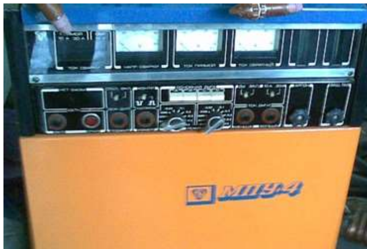
Рисунок 1.1 – Внешний вид источника «МПУ-4»
