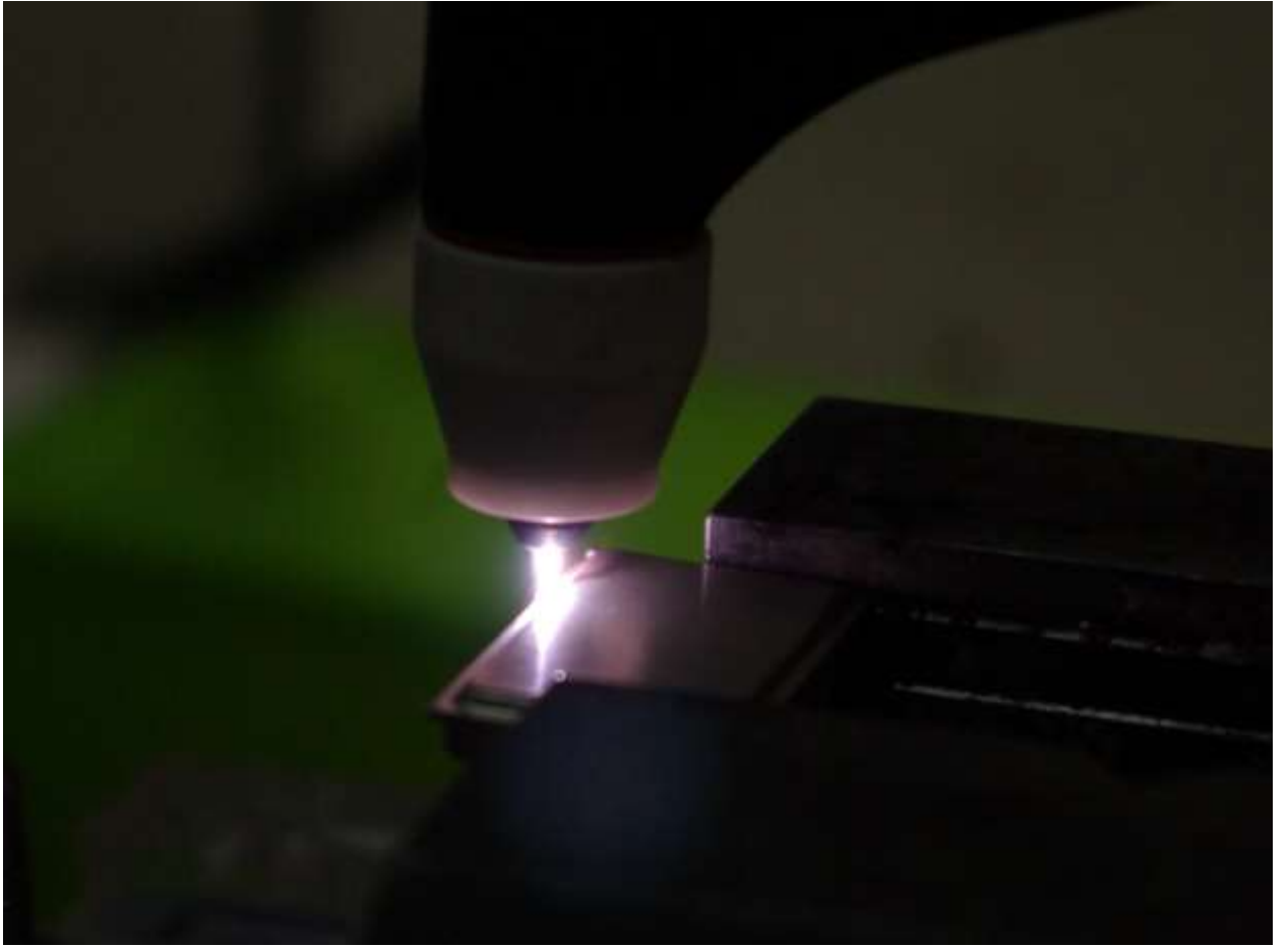
Рисунок 6.41. Сварка со стороны крышки
