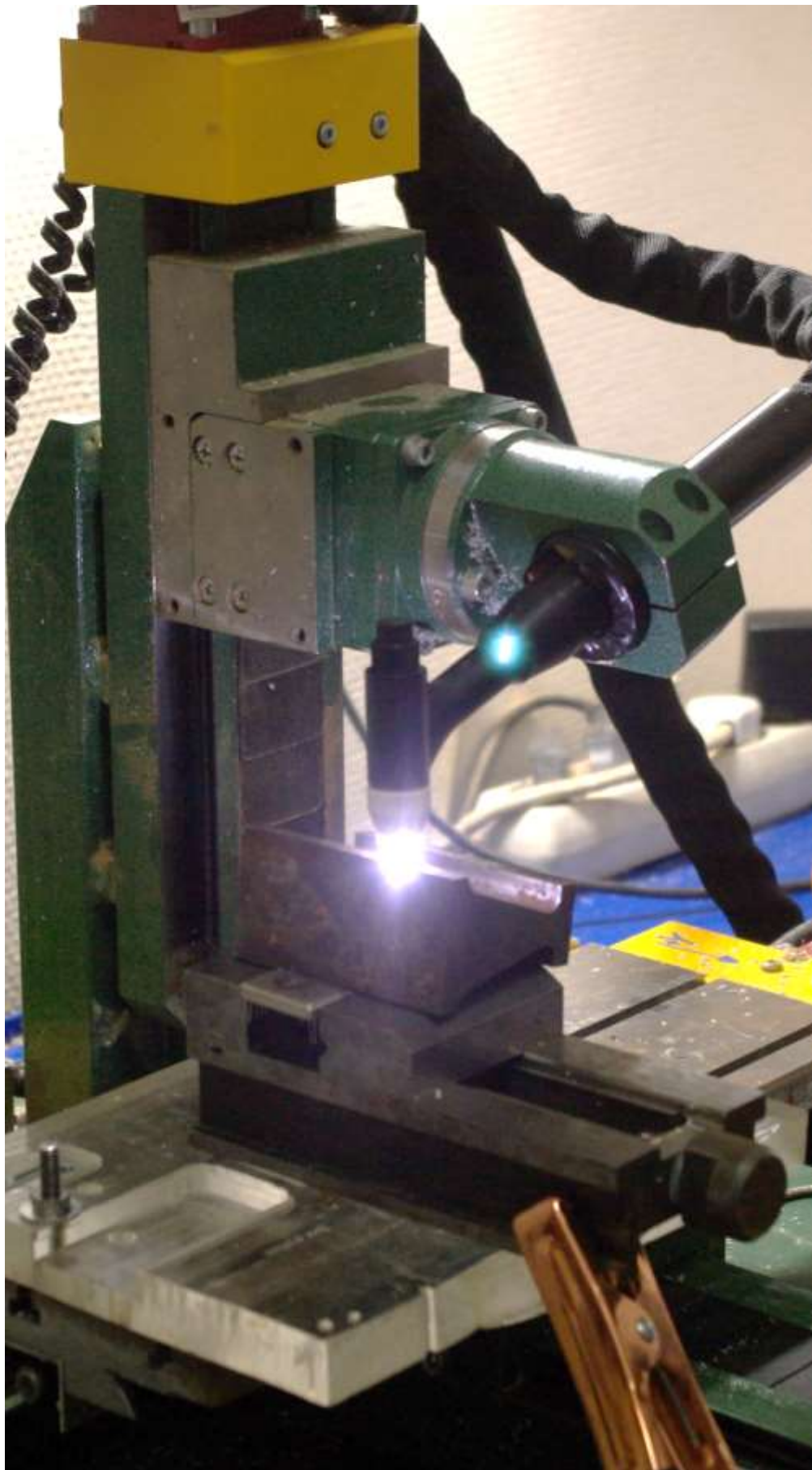
Рисунок 6.20. Вид микроплазменной дуги, горящей на массивном основании.
