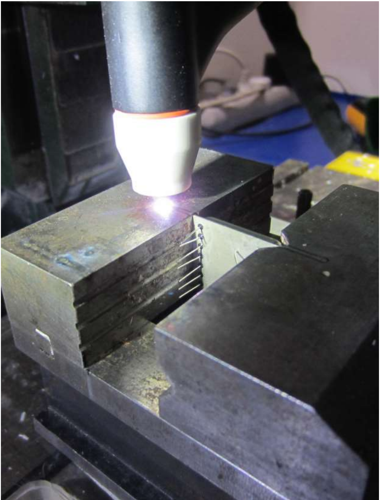
Рисунок 6.22. Горение только сварочной дуги
